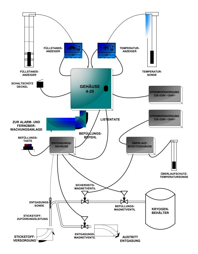
Gesamtschema eines Kryogenbehälters mit GEHÄUSE 4-20
