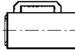
Typ "G-C" Standard Umhüllung ALU glatt blau beschichtet mit Griff
