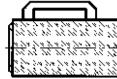
Typ "G - CAL" Sonder- ausführung, Umhüllung ALU Stucco mit Griff
